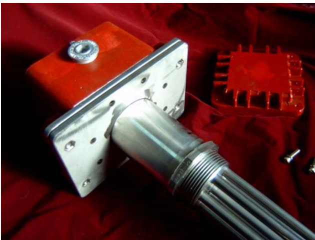
사진 3. HDC-340-3P 히터의 플랜지, 소켓부, PLUG의 조립된 사진
